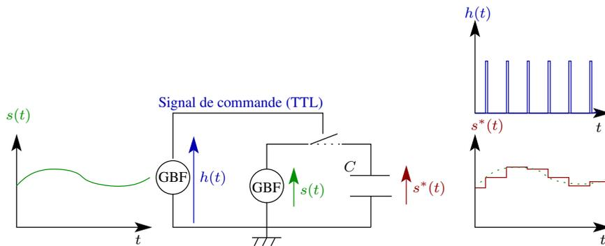
FIGURE 3.2 – Schéma fonctionnel du bloqueur
