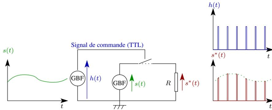
FIGURE 3.1 – Schéma fonctionnel de l'échantillonneur
