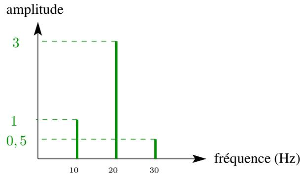
FIGURE 2.2 – Sortie de l'analyseur de spectre lorsque l'entrée est  $s(t)$ .
