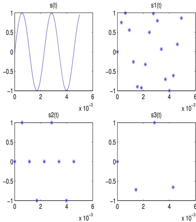
FIGURE 5.1 – Signal  $s(t)$  original et signaux  $s_1(t)$ ,  $s_2(t)$  et  $s_3(t)$  obtenus par échantillonnage
