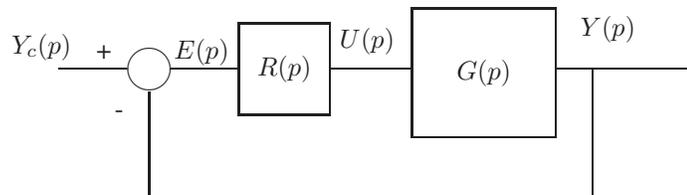
FIGURE 4.1 – Système avec correcteur
