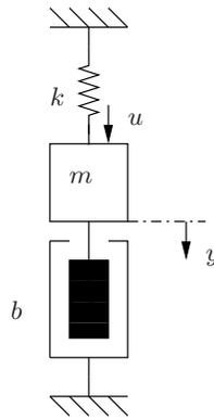
FIGURE 1.4 – Exemple de système mécanique
