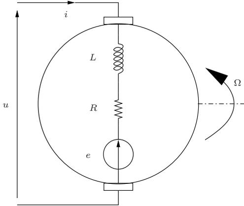
FIGURE 1.7 – Modèle du moteur à courant continu
