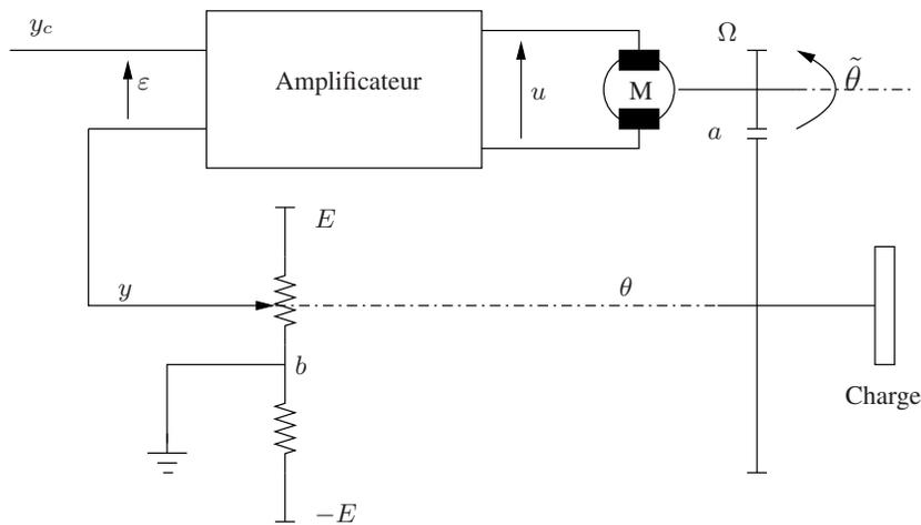
FIGURE 1.6 – Schéma de principe de l'asservissement de position angulaire
