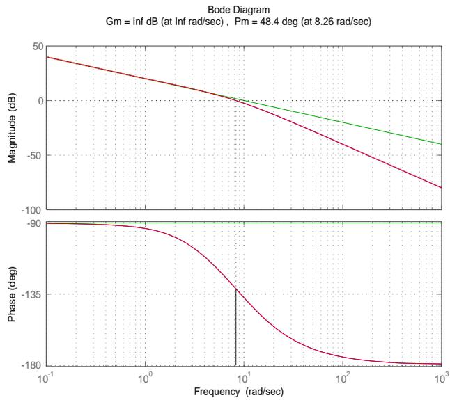
FIGURE 5.4 – Réponses fréquentielles de  $L(p)$  et  $L_s(p)$
