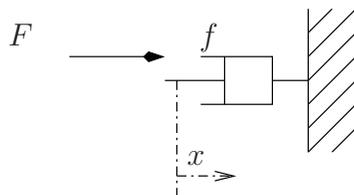
FIGURE 1.2 – Système à amortisseur
