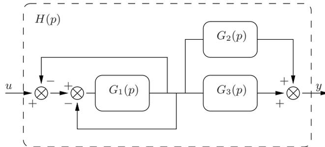
FIGURE 1.8 – Schéma-bloc du système global
