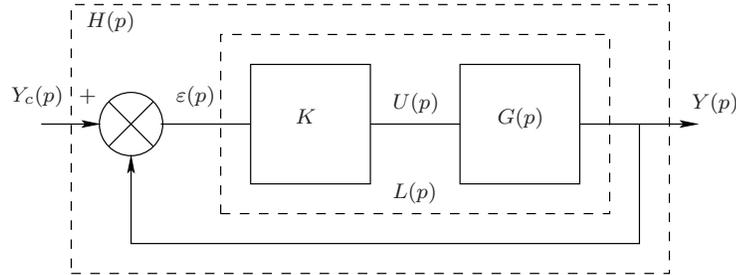
FIGURE 3.1 – Système bouclé
