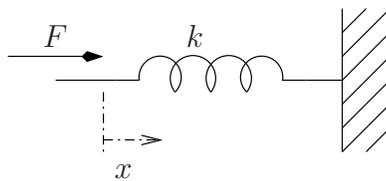
FIGURE 1.1 – Système à ressort
