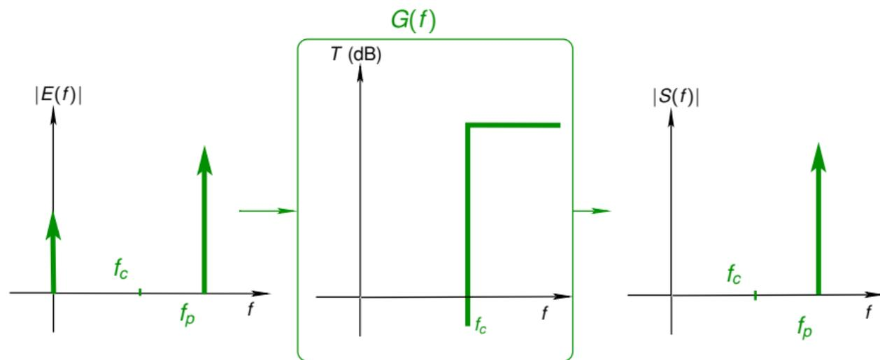
Figure: Exemple de filtrage passe-haut : élimination d'un *offset*
