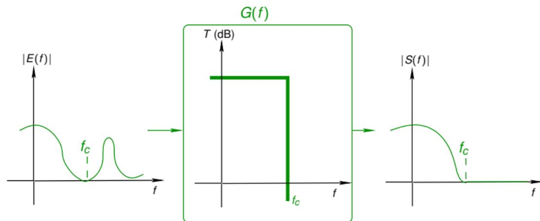
**Figure:** Exemple de filtrage passe-bas : élimination d'un bruit de hautes fréquences
