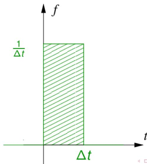
Pour définir l'*impulsion de Dirac*, il faut faire tendre  $\Delta t$  vers 0 et donc  $\frac{1}{\Delta t}$  vers l'infini. L'impulsion devient donc infiniment fine, infiniment haute et de surface 1. On note une telle impulsion  $\delta(t)$  :
