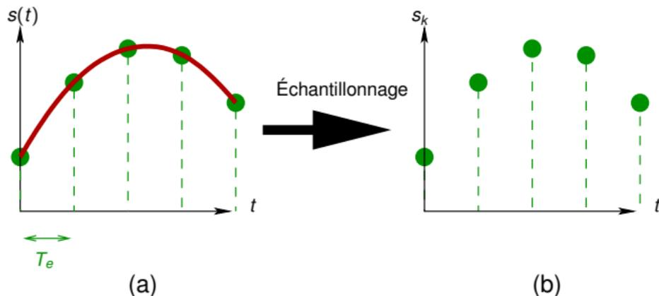
Figure: Processus d'échantillonnage
