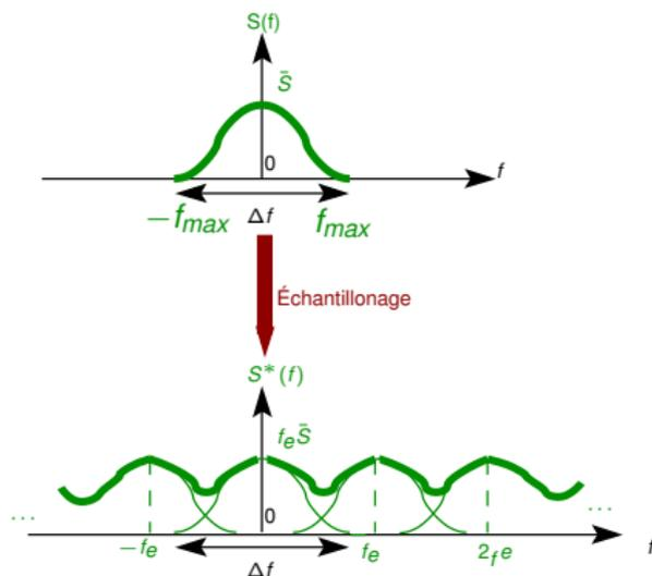
Dans un tel cas, il est impossible de récupérer  $S(f)$ , même par un filtre idéal. L'information sur  $s(t)$  est perdue ! On parle alors de *repliement de spectre* ou *recouvrement de spectre*.
