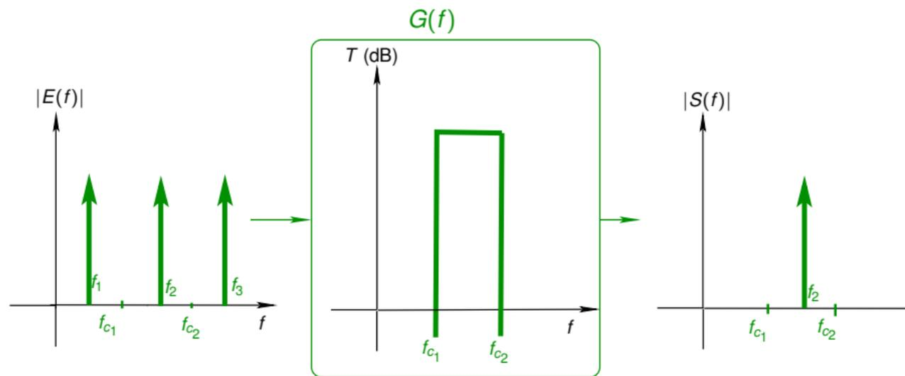
**Figure:** Exemple de filtrage passe-bande : isolation d'une fréquence (ex : radio)
