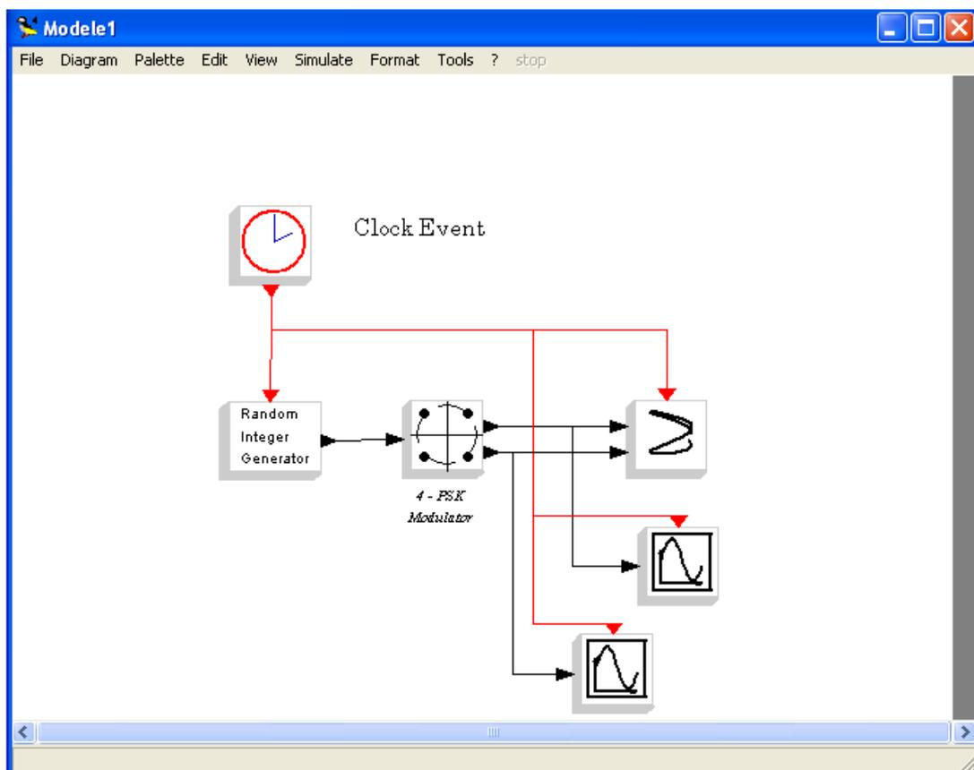
Le schéma se compose d'une horloge d'événement qui active chaque bloc et des blocs suivants :
