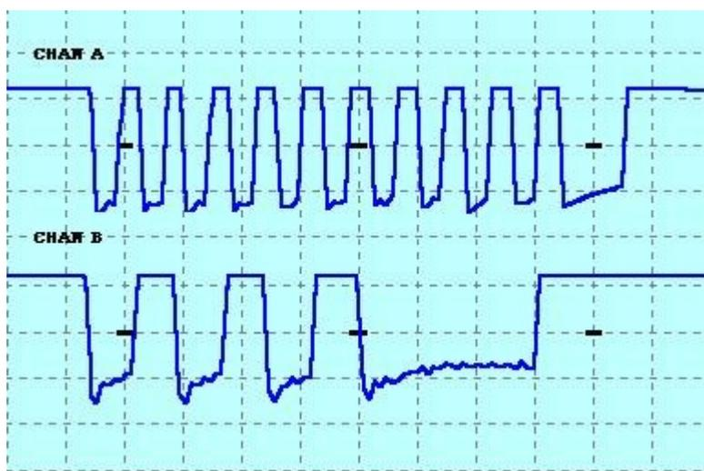
La fréquence d'horloge est de 10-16.7 kilohertz. Le temps à partir du front de montée d'une impulsion d'horloge à une transition de données doit être au moins de 5 micro-secondes. Le temps d'une transition de données au front de descente d'une impulsion d'horloge doit être au moins de 5 micro-secondes et pas plus grande que 25 micro-secondes.
